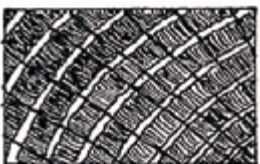
Snabbvuxen ek får större andel mörk sommarved. Virket blir hårt och tungt.
