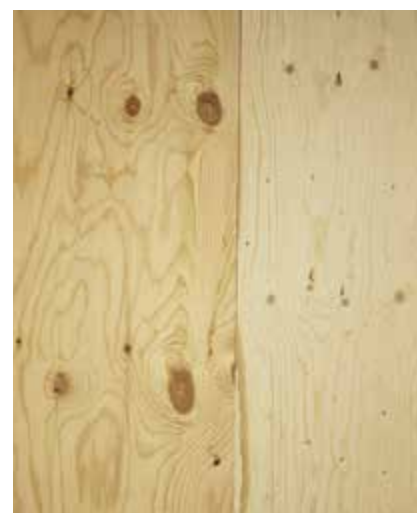
Plywood som tydligt visar skillnaden mellan tall- och granvirke. Tallens kvistar är rödaktiga och saknar de små pärlkvistar mellan grenvarven som finns på granplywooden till höger.
