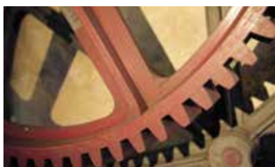
Mall skuren i al till en gjutform för kugg-hjul vid Brevens bruk. Foto: Lars Klingström
