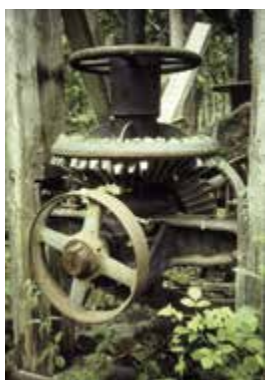
Kuggar av avenbok vid en gammal vattenturbin i Rättvik.
